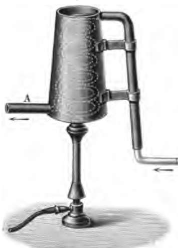
Überhitzen von Wasserdampf.
